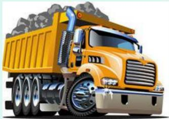
> Le camion le plus couramment utilisé est d'un ptac de 32to soit 17to de charge utile
